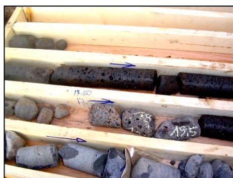
Analyse des carottes des forages pour la détermination géologique
