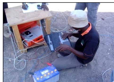
Acquisition des données magnétotelluriques pour identifier les réservoirs géothermiques en profondeur
