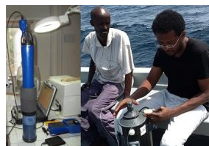
Photo3 Etalonnage de la sonde multiparamètre YSI au laboratoire et prélèvement des échantillons d'eau de mer pour les mesures in situ des indicateurs environnementaux et biologiques
