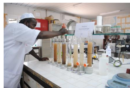
Caractérisation de la texture du sol par analyse granulométrique
